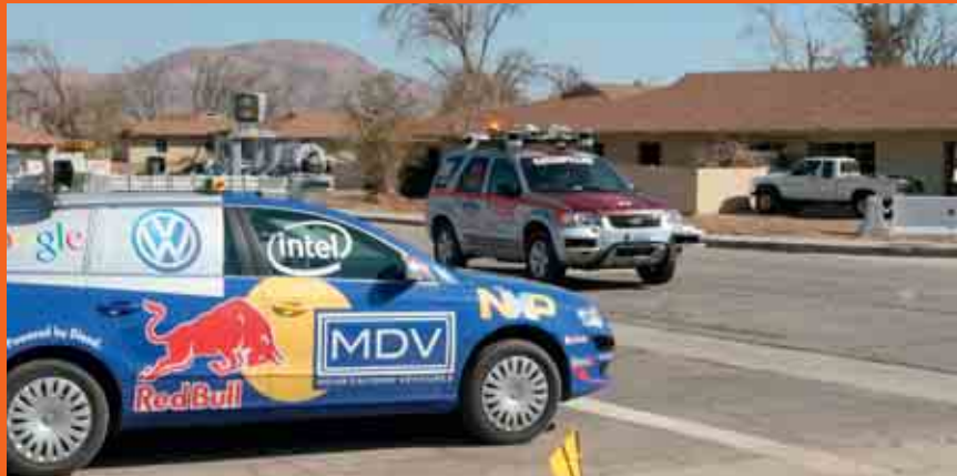
TWEE ONBEMANDE ROBOTAUTO'S GEVEN EN NEMEN FOUTLOOS VOORRANG IN DE DOOR DARPA GEORGANISEERDE WEDSTRIJD URBAN CHALLENGE. OP DE DAKEN ALLE SENSOREN DIE HUN INFORMATIE DOORGEVEN AAN DE AUTO EN AAN DE CONTROLEKAMER MET OPERATORS.
